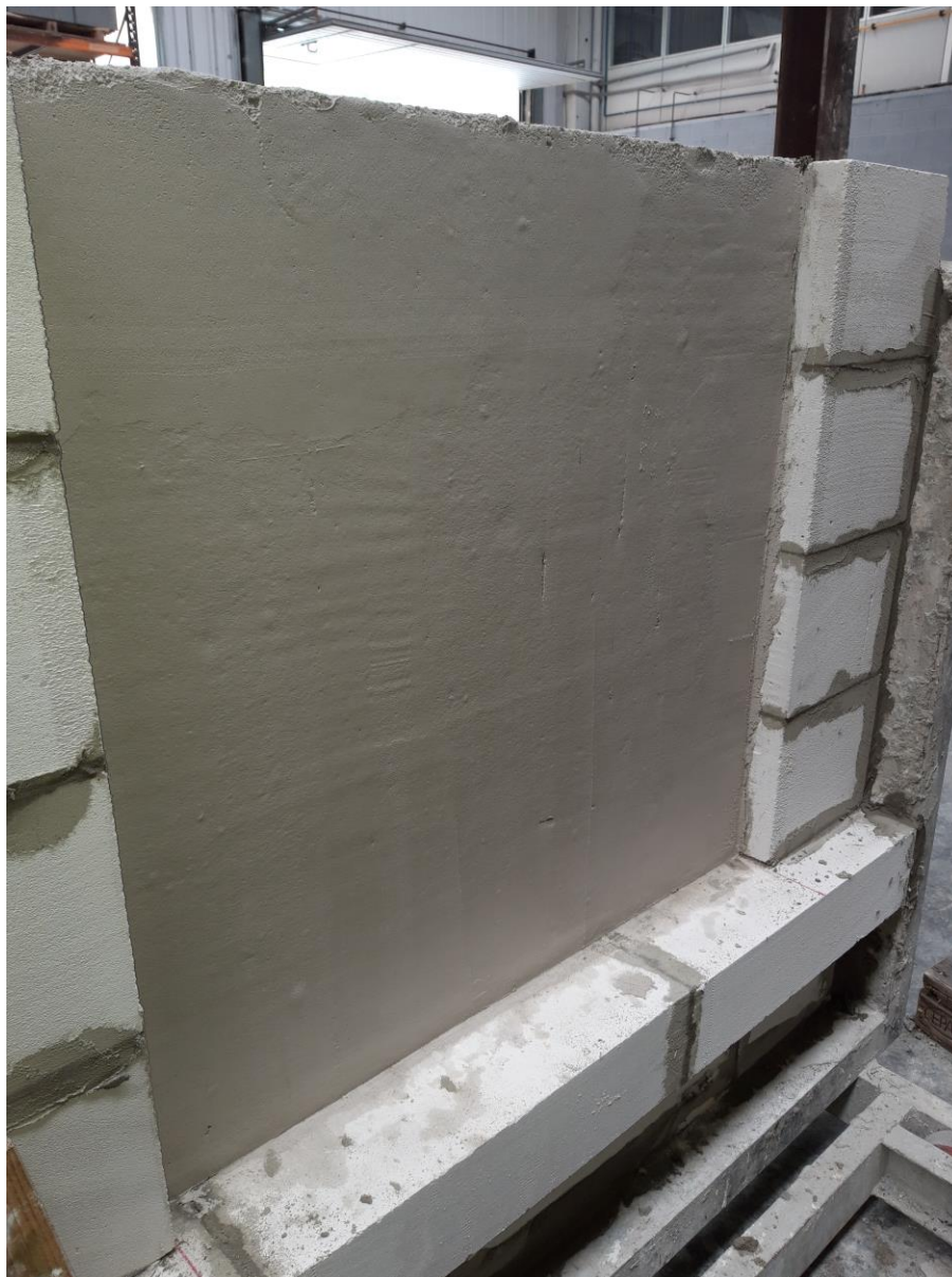
Fotografía 3: Aspecto de la muestra antes del ensayo, cara expuesta.
