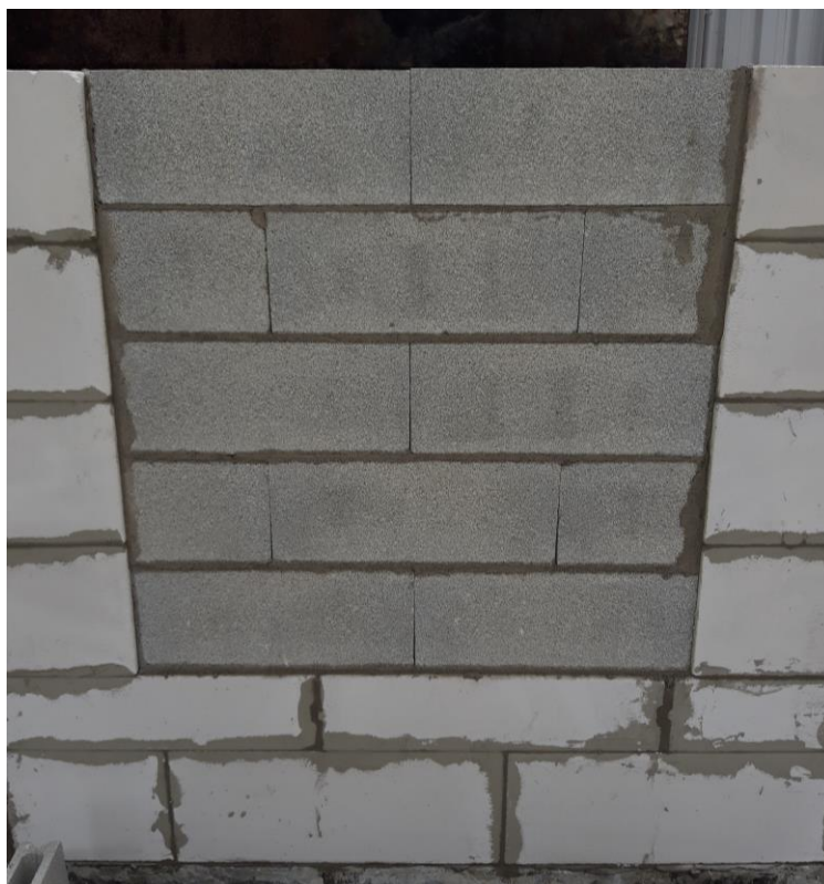
Fotografía 1-2: Montaje de la muestra.
