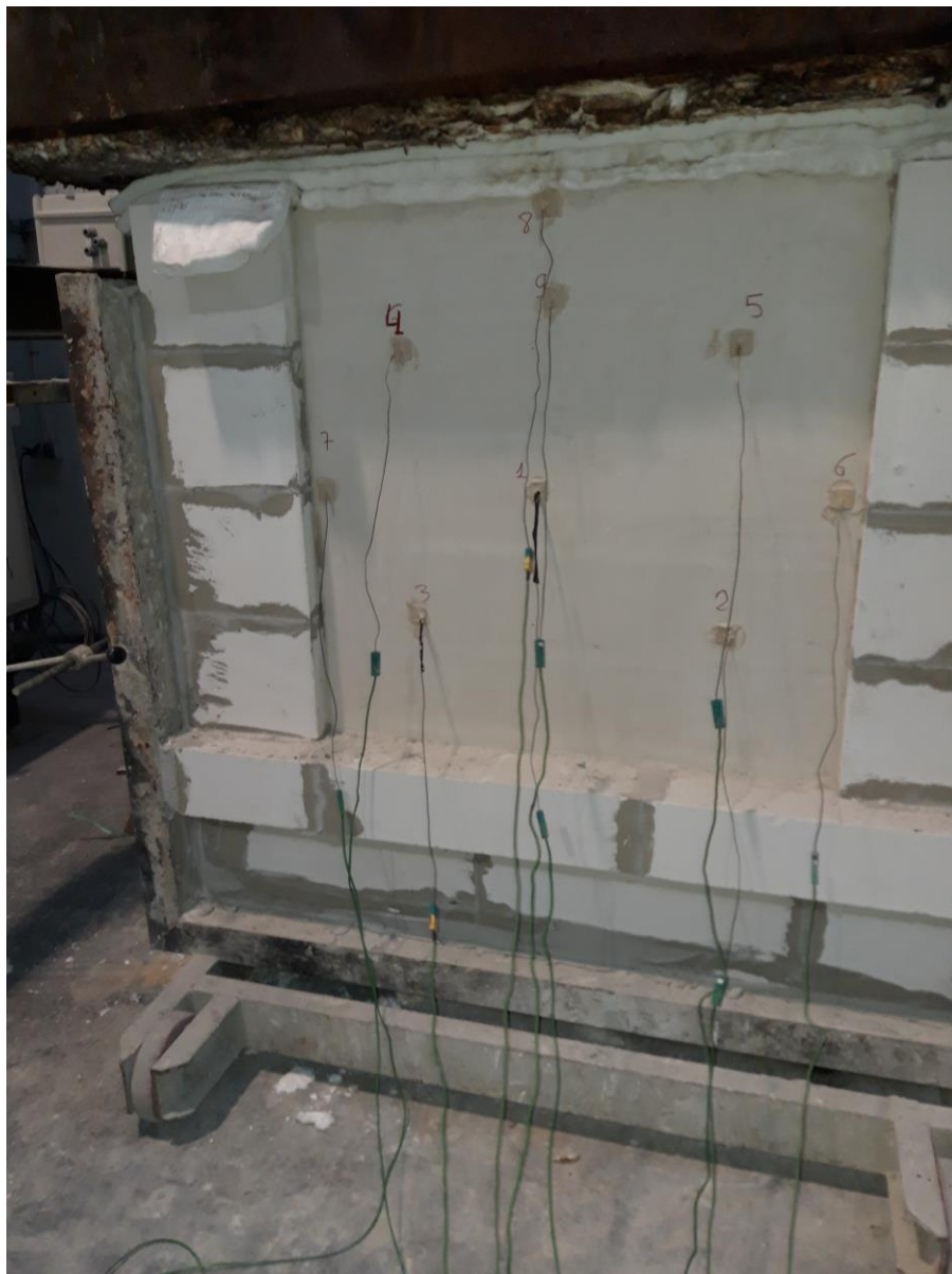
Fotografía 4: Aspecto de la muestra antes del ensayo, cara no expuesta.
