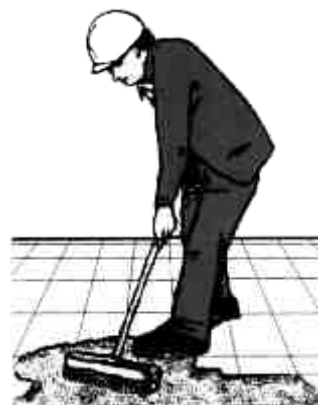
5 Sellado de juntas con arena y nueva compactación.
